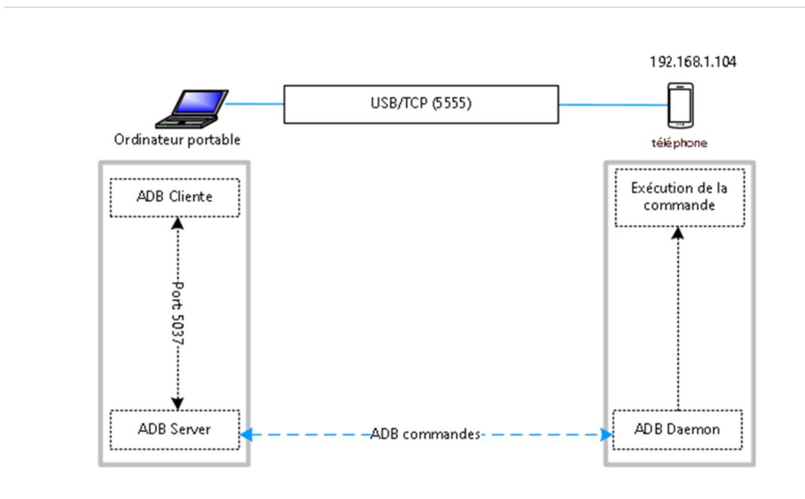
Figure 11 – Commande USSD à distance à l'aide de l'interface système ADB
